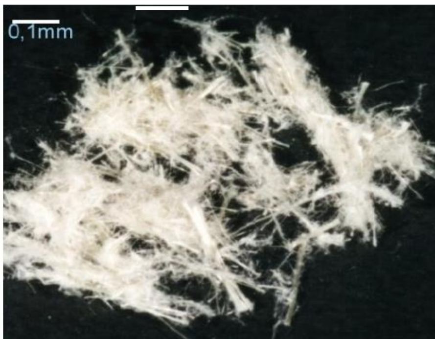
Rysunek 1 Azbest chryzotylowy, tzw. twardy, krótkowłóknisty, zawiera \text{CaCO}_3
